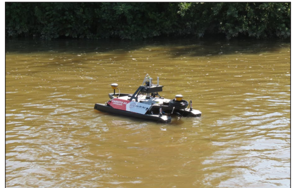
Ingenieurs van Jan De Nul gebruiken de Dender om hun meetinstrumenten te testen en klaar te maken voor het werkveld. Deze varende robot registreert bodemprofielen met behulp van sonar.
